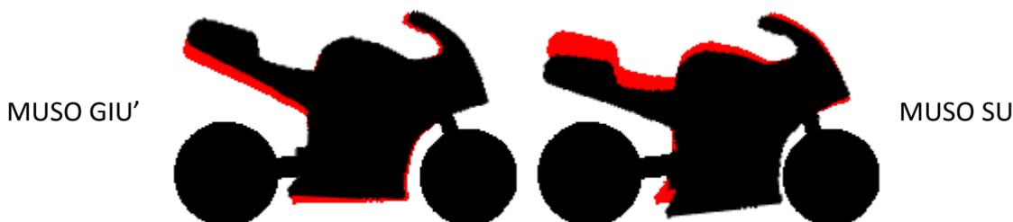
Si possono “sfilare di qualche millimetro” le forcelle anteriori, questo causerà un abbassamento della moto sull’anteriore “non una riduzione della corsa” la moto avendo così un angolo di sterzo ridotto entrerà in curva con più facilità non migliorerà la velocità di percorrenza e ridurrà la luce “carena-suolo” attenzione, così come si può allungare o accorciare l’interasse della moto spostando il perno ruota posteriore “logicamente riaggiustando la catena!”.
